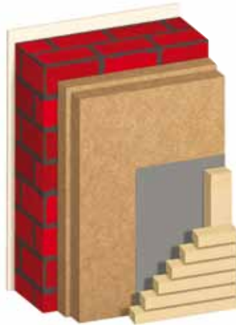
Construction ventilée sur un mur
