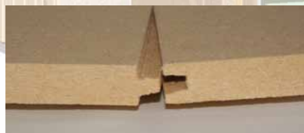
transversal de la rainure et de la languette
