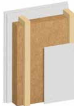
Cloison légère à montants en bois avec GUTEX Thermoflex/GUTEX Thermosafe homogen
