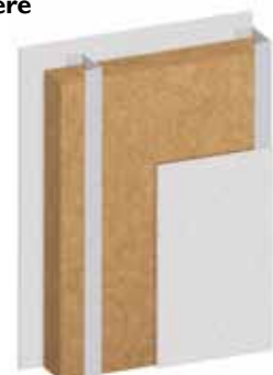
Cloison légère à montants en métal avec GUTEX Thermoflex/GUTEX Thermosafe homogen
